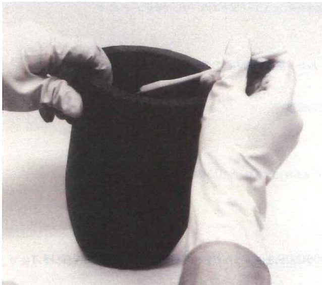
グラファイト炉ツボの酸化防止に 36L を刷毛塗りする
