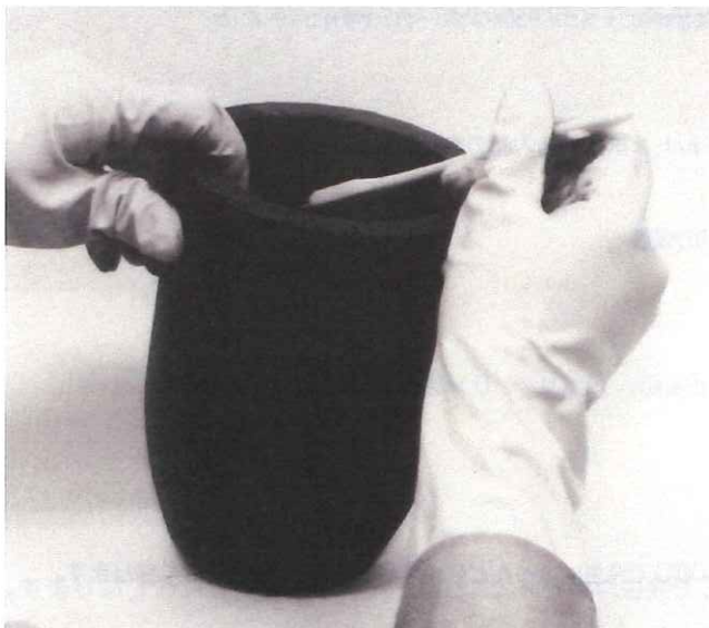
グラファイトルツボの酸化防止に 36L を刷毛塗りする
